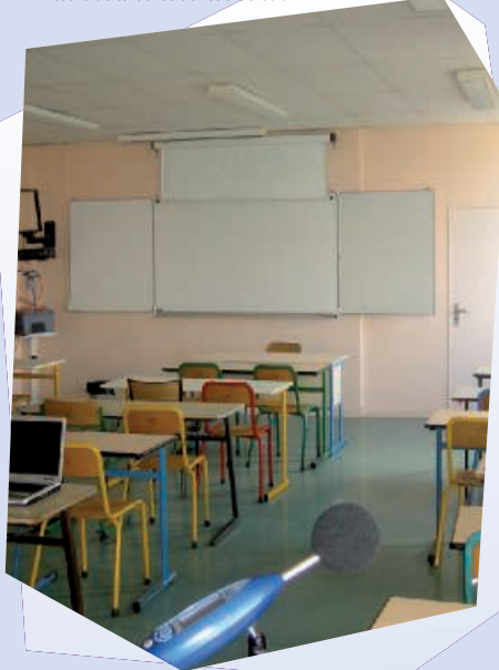
Mesure de la durée de réverbération
